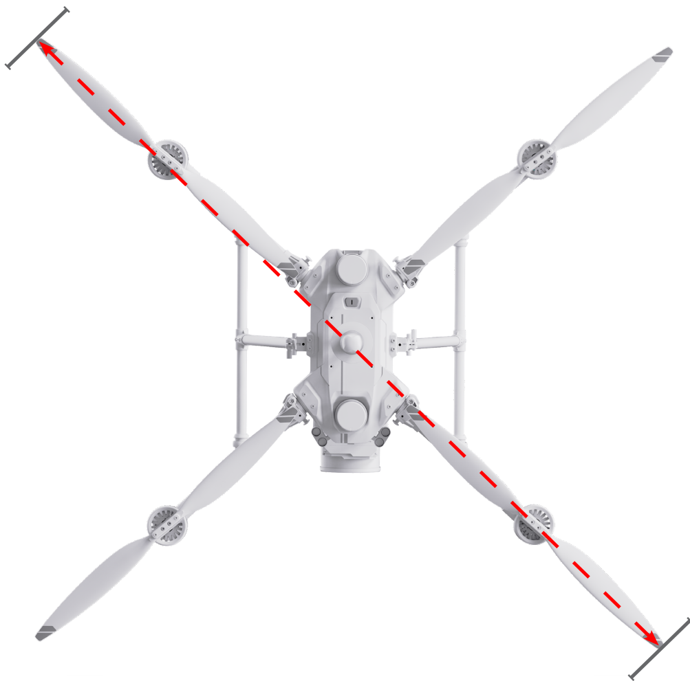
Propeller vollständig ausgefahren (1250 mm)
